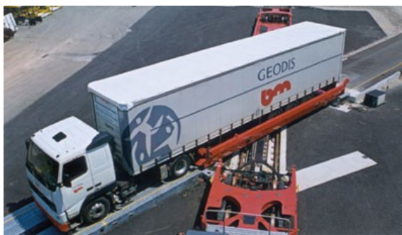
Foto: sistema de carga Modalohr, en le Boulou
