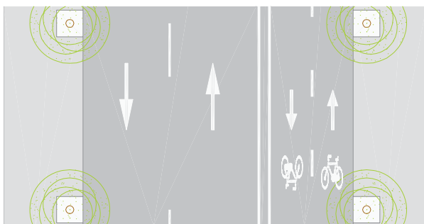
e. Detall senyalització horitzontal per a carril bici bidireccional.
