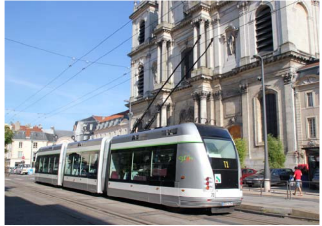
Imatge del TVR de Nancy, considerat com a BHNS, dotat d'un carril de guiatge central i tròlei. (Foto: Ricard Riol Jurado)
