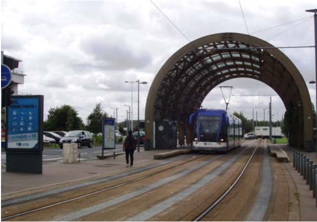
Imatge del TVR de Caen, considerat com a BHNS, dotat d'un carril de guiatge central i pantògraf (Foto: Lluís Avellana, 2012).
