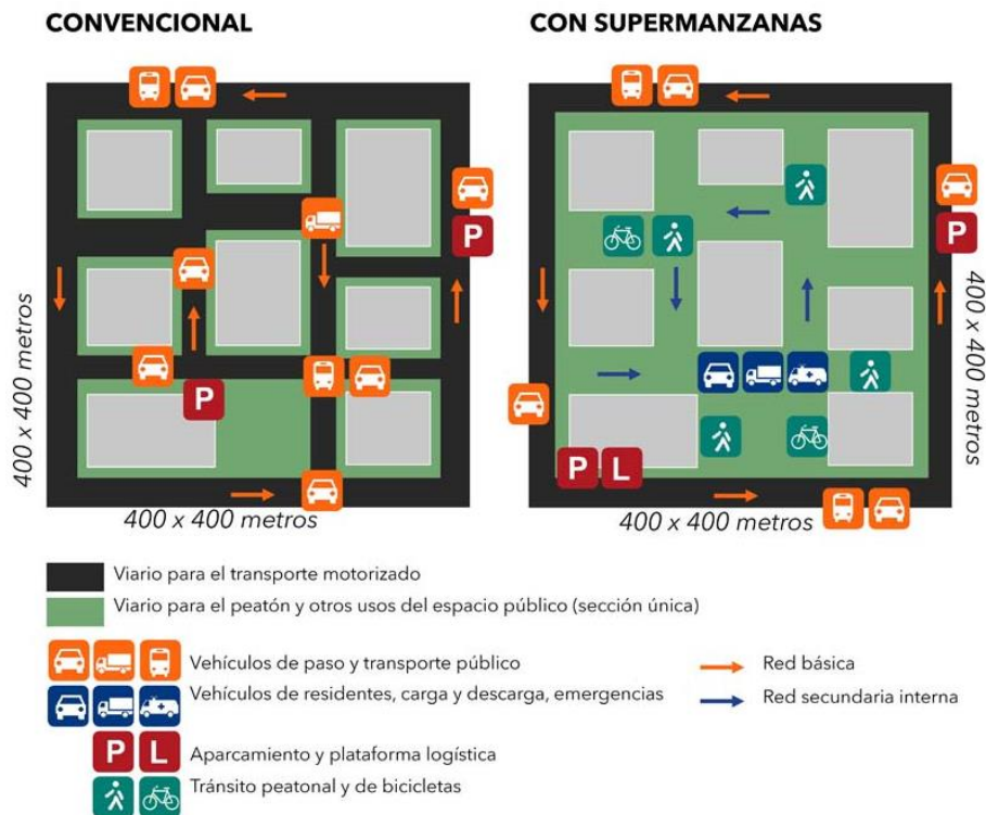
Figura 3. Superilla que integra la xarxa ciclista principal als carrers pacificats de l'interior o intervies
