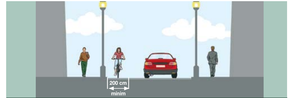
Figura 7.- Carril bici a contracorrent del trànsit motoritzat
