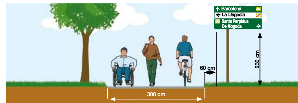
Figura 43.- Col·locació dels plafons d'orientació
