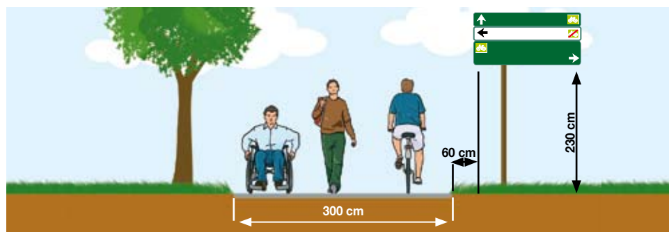
Figura 43. Colocación de los paneles de orientación
