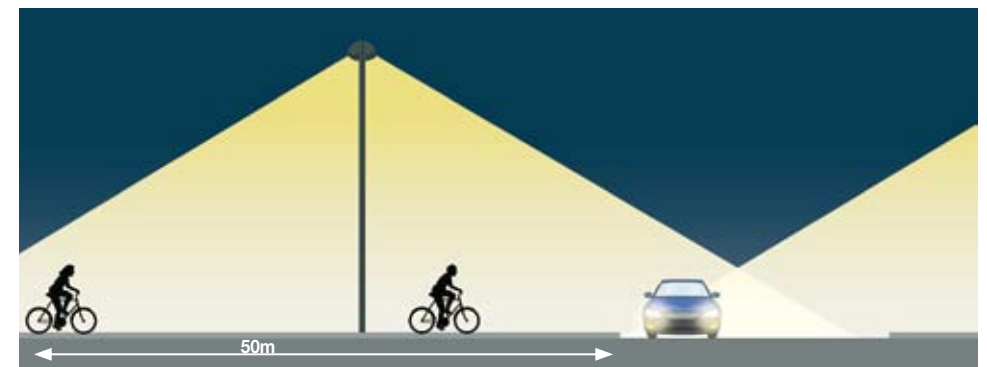
Figura 55.- Alumbrado en las intersecciones
