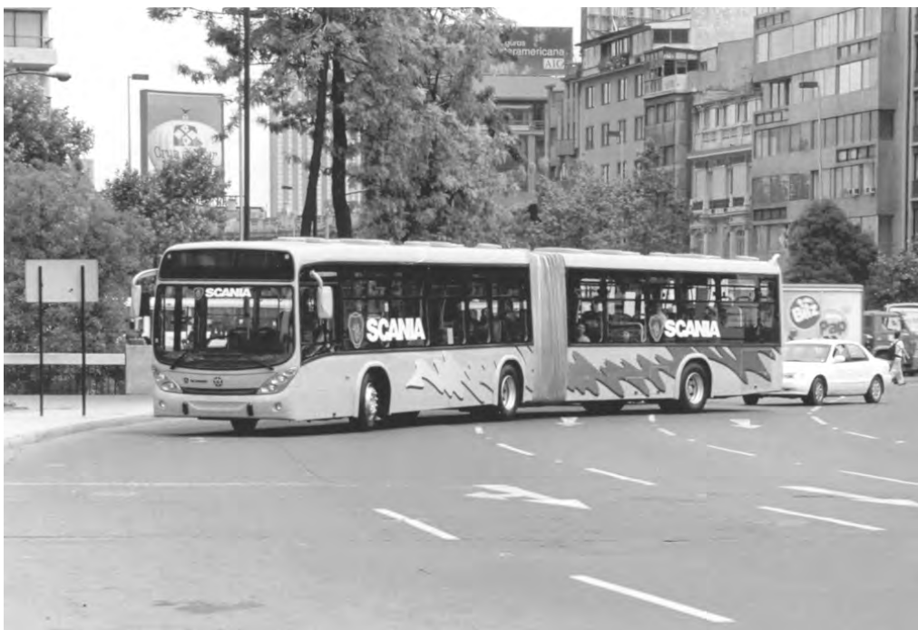
Autobús articulado de 18,2 metros, fabricado por Scania, con una capacidad para 152 pasajeros y con el 55 % en piso bajo.
