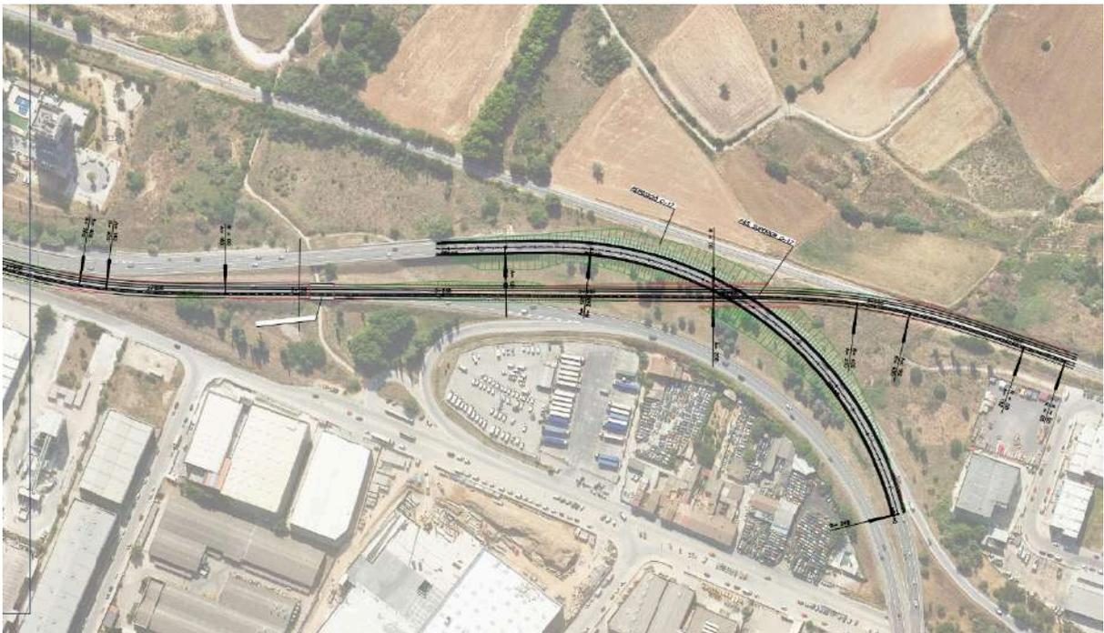
Fig 9: Trazado en planta entre los P.K. 2+900 y 3+600.
