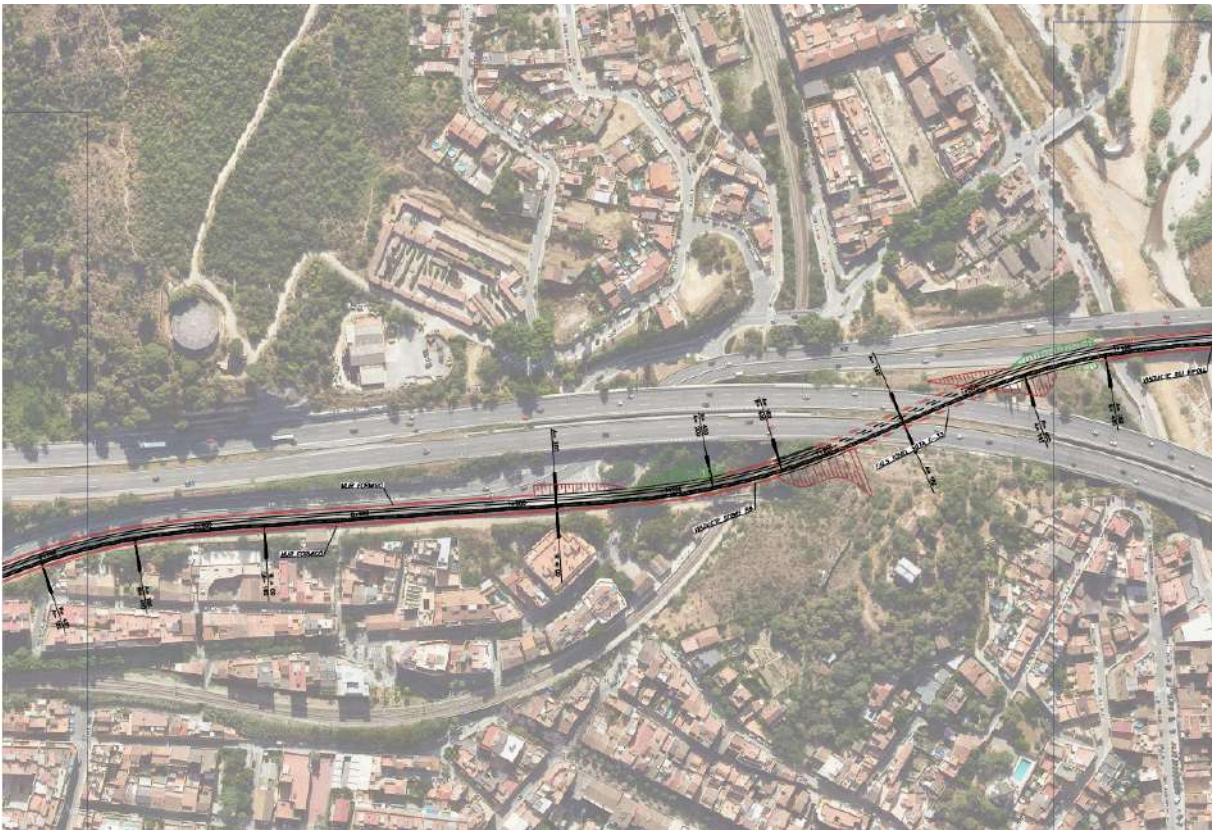
Traçat en planta entre els P.K. 0+700 i 1+400.
