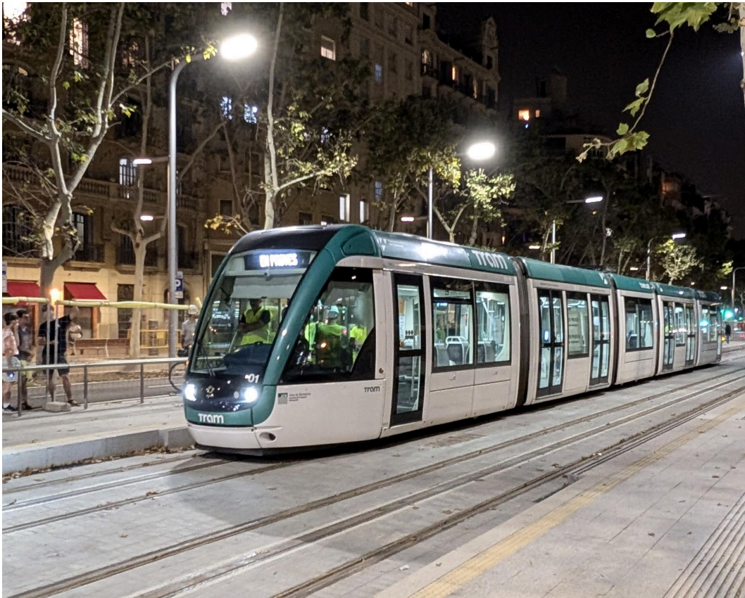
El Trambesòs fent proves a la Diagonal de Barcelona, entre Glòries i Verdaguers, sense catenària i captant l'energia del terra de forma totalment segura
