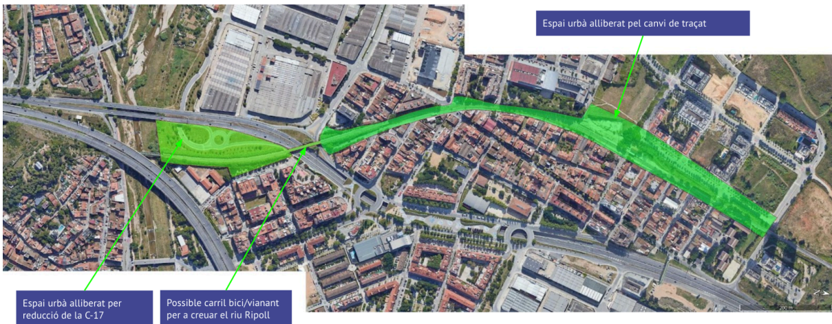
Fig 5: espai viari i ferroviari alliberat a l'àmbit del traçat actual de l'R3.
