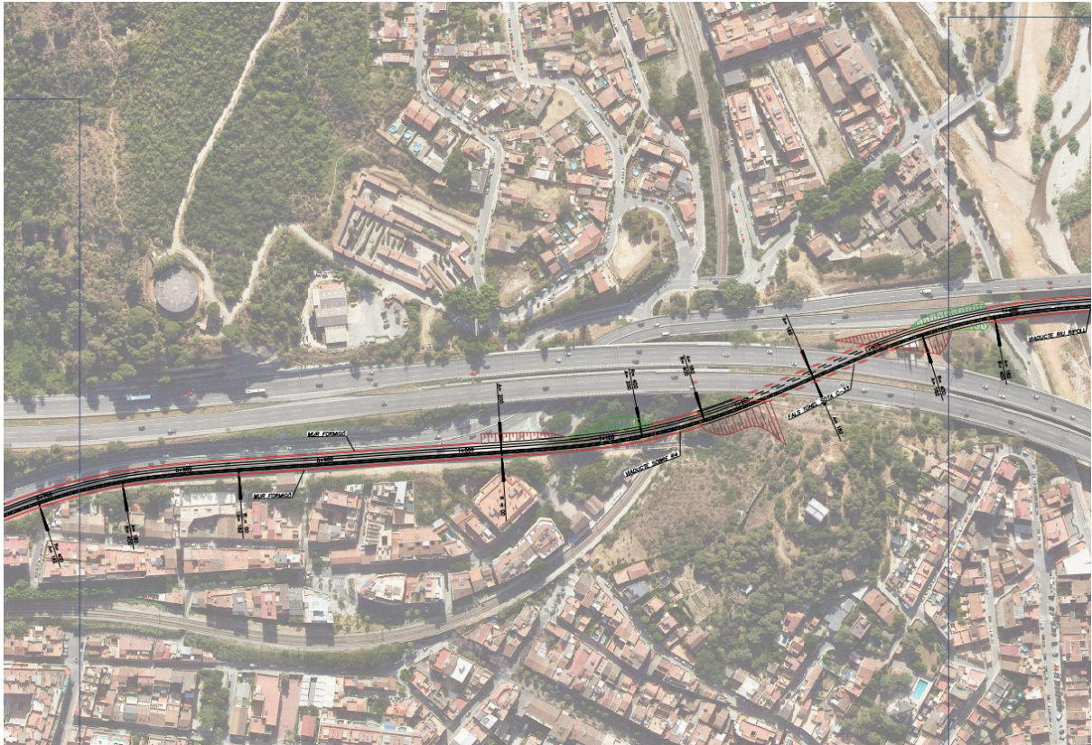
Fig 6: Traçat en planta entre els P.K. 0+700 i 1+400.
